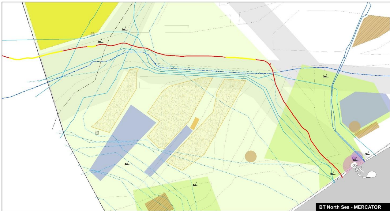
Figuur 10.3.3: Mogelijke pre-sweeping zones (in geel), noodzaak te bevestigen op basis van gedetailleerde technische analyse
