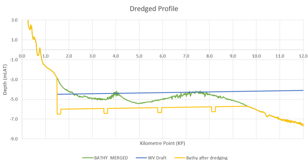
Figuur 2-3: Zeebodemprofiel langs het toegangskanaal (LOT2). WV: Willem de Vlaming
