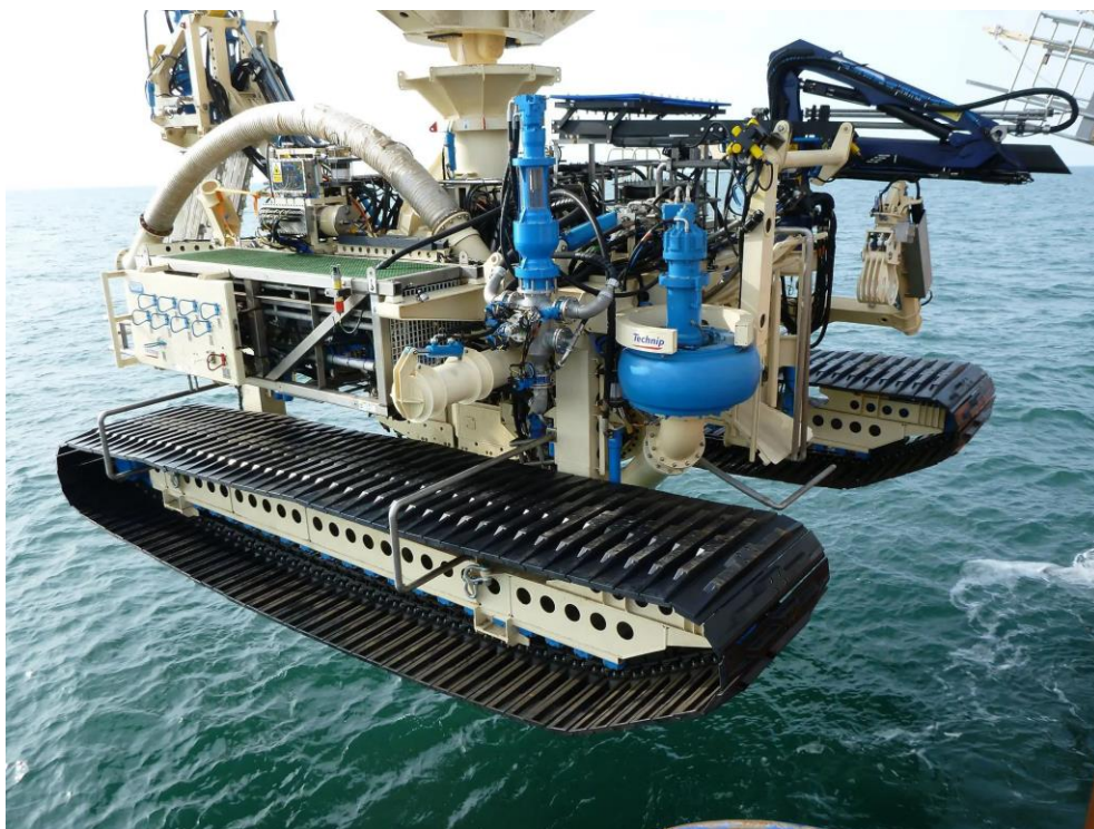
Figuur 2-8: Illustratie jet trencher van DEME (voordien van Technip) ( https://www.nauticexpo.com/prod/smd/product-40164-317045.html )
